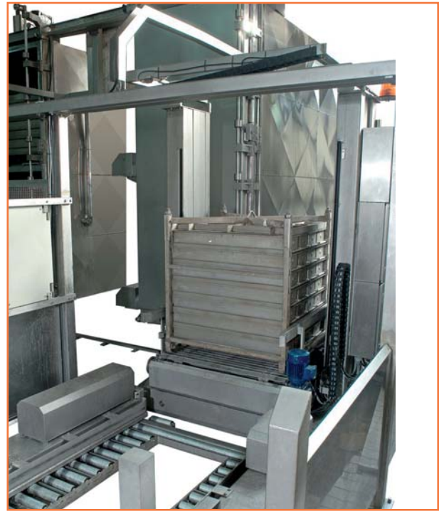
| El Robot Universal de Carga Autoload 5000 automatiza el proceso de carga y descarga de cualquier tipo de multimoldes, cestas de cocción o contenedores alimentarios | AutoLoad 5000 Universal Loading Robot automates the loading / unloading process of any type of multimoulds, cooking baskets or food containers
