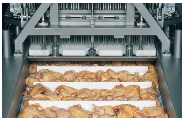
! Marinado de partes de pollo por efecto "spray" ! Poultry parts spray marination
